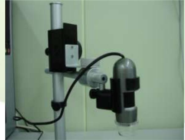
200倍電子式偏光顯微鏡
